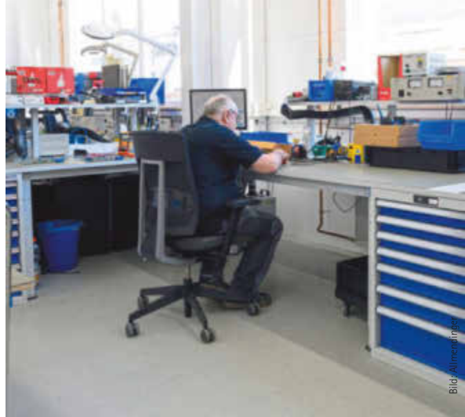
Für die tägliche Arbeit sind Löttechnik, Lupen und Mikroskope genauso erforderlich wie eine Rework-Station
