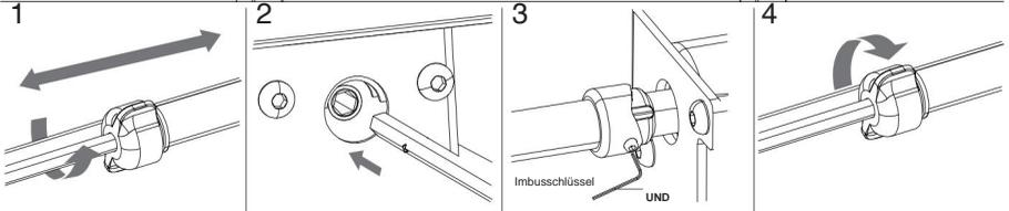
1 Lösen Sie den Knopf der Antriebsstange.
